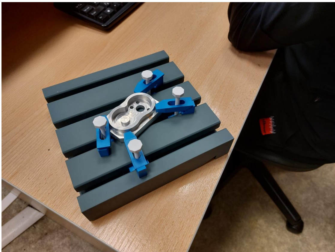
Obr. 3: Kompletní sestava pro upnutí frézované součásti
