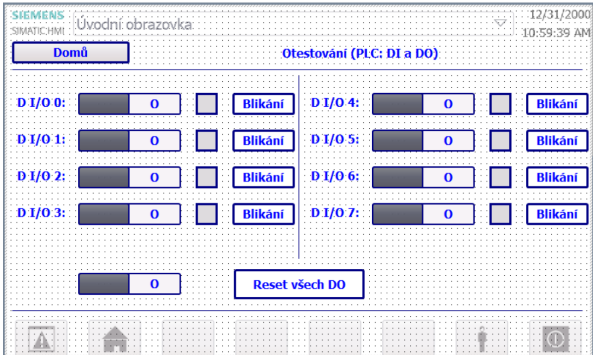
Obrázek 31: Vizualizační aplikace – obrazovka s názvem „Otestování (PLC: DI a DO)“, která obsahuje testovací panel jednotlivých digitálních výstupů PLC, propojených s modulem křižovatky
