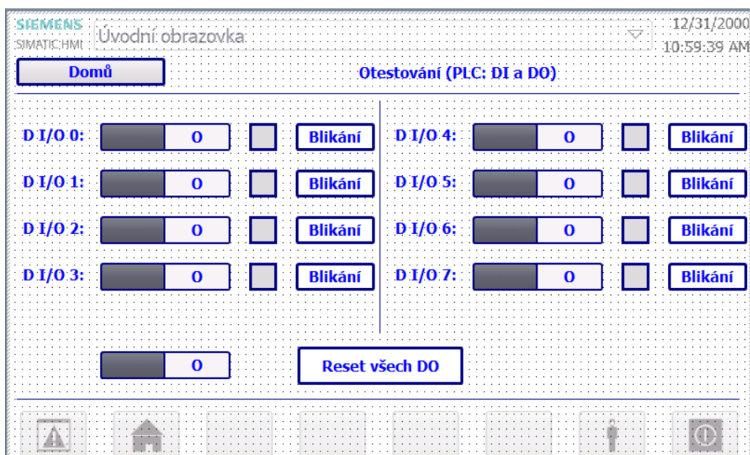
Obrázek 15: Testování vstupů pro ovládání modulu křížovky – vizualizace určená pro HMI panel v prostředí TIA Portal
