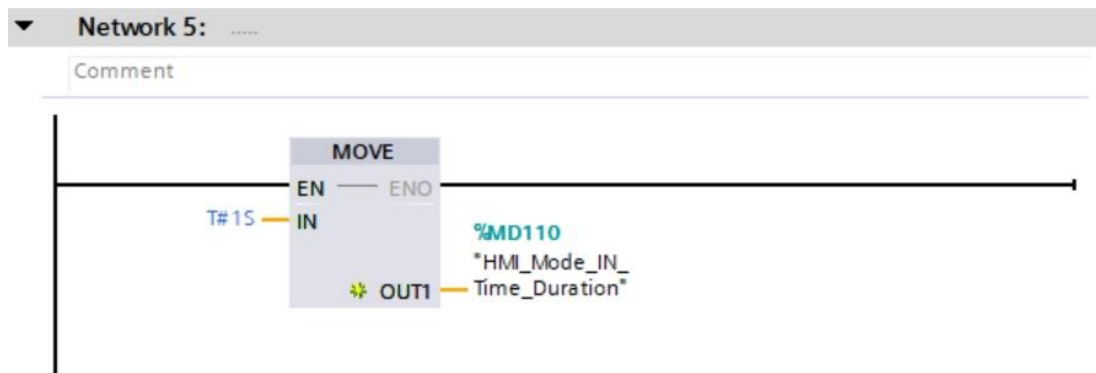
Obrázek 20: Start-up (OB100):Network 5: Inicializace programu Křižovatka (proměnná „HMI_Mode_IN_Time_Duration“; datový typ Time, inicializační hodnota činí 1 s)
