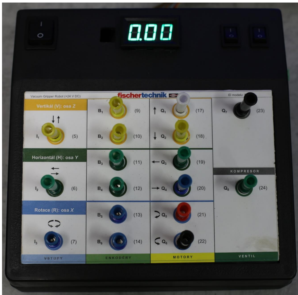
Obrázek 5: Prototyp propojovacího rozhraní pro připojení tříosých manipulátorů Fischer Technik k PLC Siemens Simatic S7-1215 DC/DC/DC
