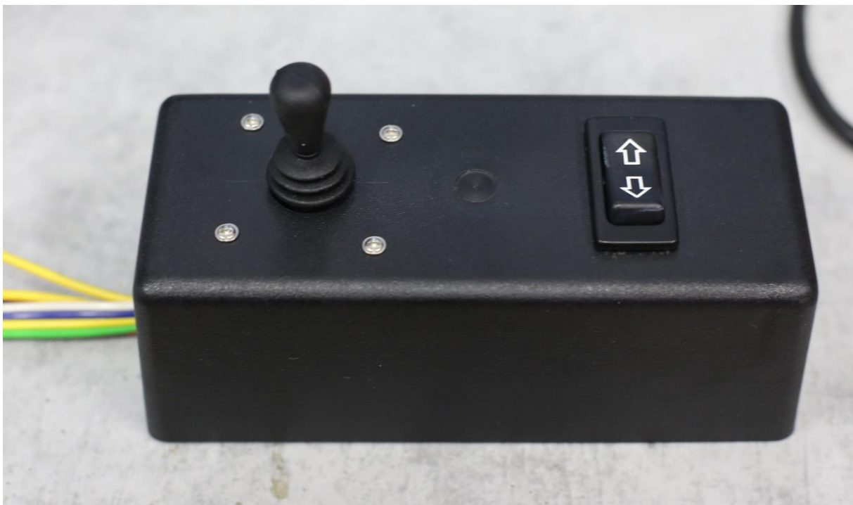
Obrázek 4: Prototyp ovládacího rozhraní (joystick) pro řízení chodu tříosých manipulátorů Fischer Technik
