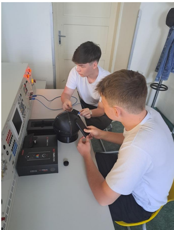
Měření světelného toku LED
