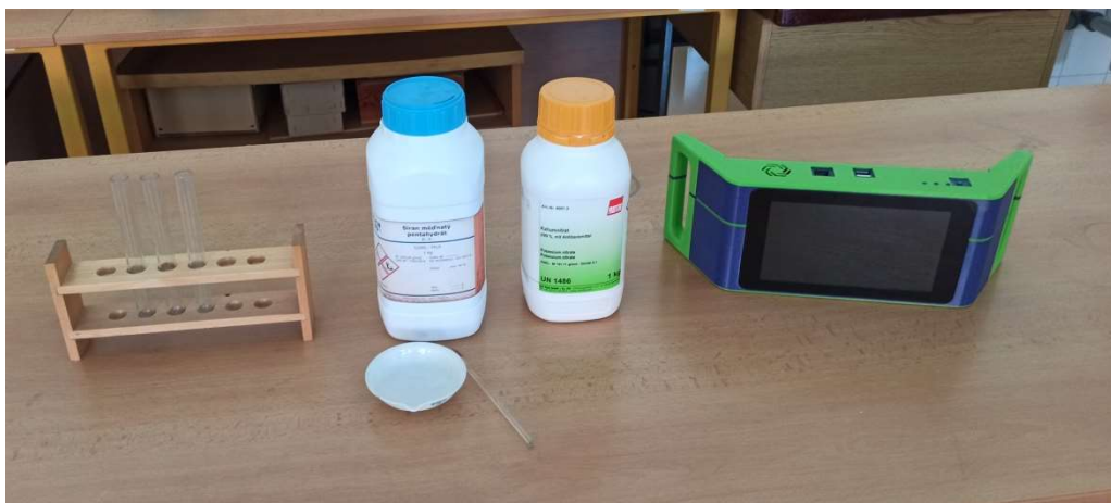
Obrázek 1 - Pomůcky - chemikálie, zkumavky, stojan na zkumavky, termokamera, skleněná tyčinka, žíhací miska
