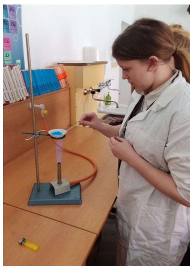
Obrázek 3 - Žihání pentahydrátu síranu měďnatého
