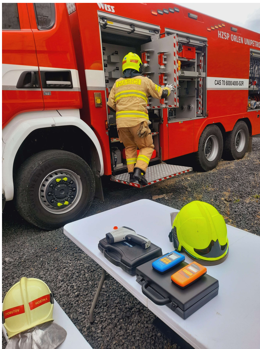
Využití oximetru, CO metru a termokamery při praktickém výcviku strojníků požární techniky v kouřovém polygonu
